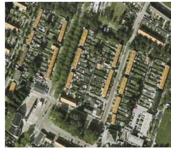
Compact in de kern Creil bestaat uit compacte, parallel lopende woningblokken in noord zuid richting. Deze oriëntatie en de diepe tuinen maken dat alle woningen evenveel zon krijgen.
